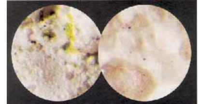
(la photo montre un enduit de finition sans et avec PMR)
