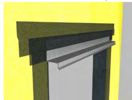
Chevaucher le système AquaFlash sur la jambe du solin au minimum de mm (2 po).
